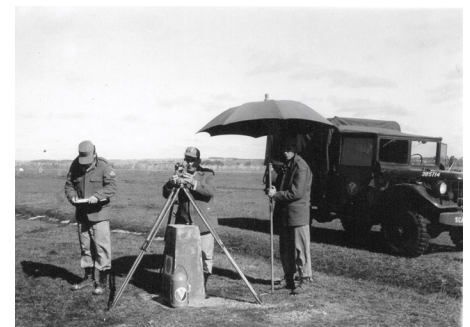
Ocupação para observações angulares do vértice ECLIPSE.
