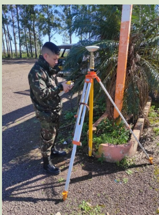
Medição de ponto de controle para georreferenciamento de imagens.
